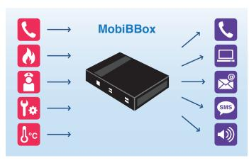
Das MobiBBox-Gateway verteilt Alarmmeldungen unter anderem mittels Text- und/oder Sprachmeldung auf alle drahtgebundenen und mobilen Endgeräte wie DECT, Wi-Fi und GSM, einschließlich Quittierungs- und Eskalationsmöglichkeiten.
