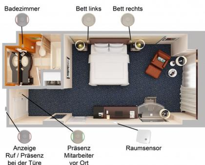
Mit Hilfe von LoRa Knöpfen kann MobiCall als vollumfängliches Rufsystem genutzt werden. Dabei werden verschiedene Funktionen, Status, Alarme durch Farben und Blinkvariationen kategorisiert. Es können beliebig viele Knöpfe installiert und konfiguriert werden. Bei Betätigung eines Knopfes wird das zuständige Personal mit allen wichtigen Informationen wie Zimmernummer, Gebäudeplan, Priorität und Grund der Benachrichtigung via Smartphone informiert.
